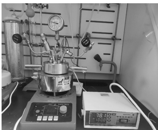
图1 秸秆水热腐殖化高压反应装置
