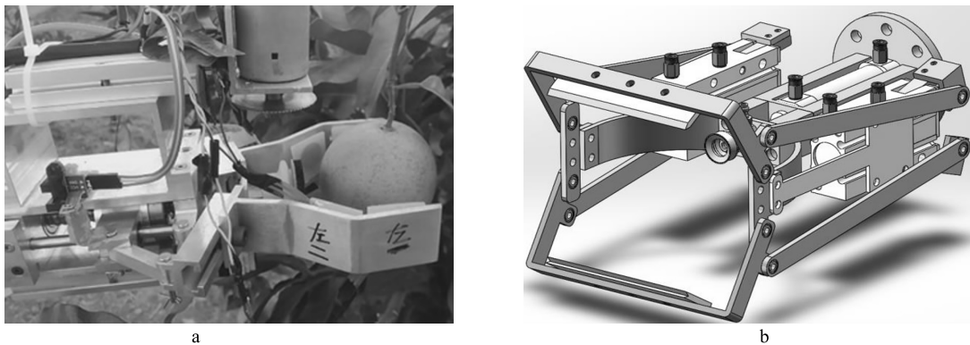
图 1 夹持切割式末端执行器
