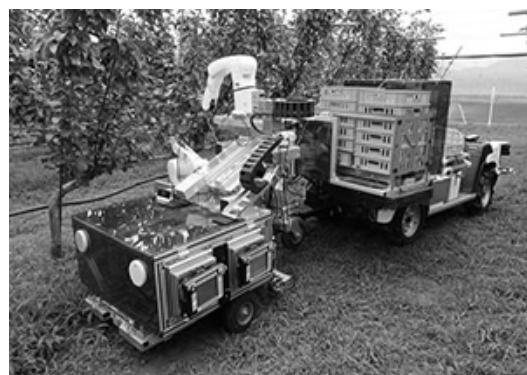
图5 日本双机械臂果实采摘机器人
