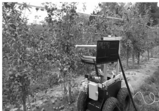
图3 气动式长冲程苹果采摘机器人
