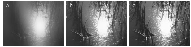
a:变分框架的Retinex法;b:双边滤波法;c:快速引导滤波法。
