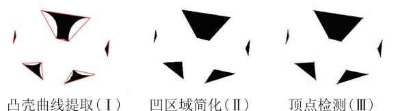
图 8 凹区域简化及顶点检测
