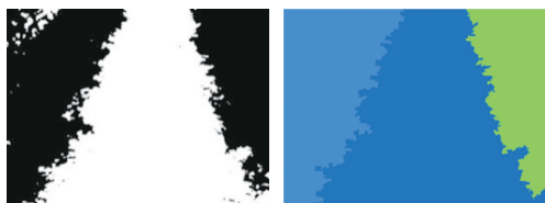
图 10 低光照条件下的果园道路图像 Ncut 算法二次分割效果
