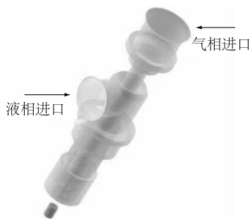
图4 两相流雾化喷头气流场模型
