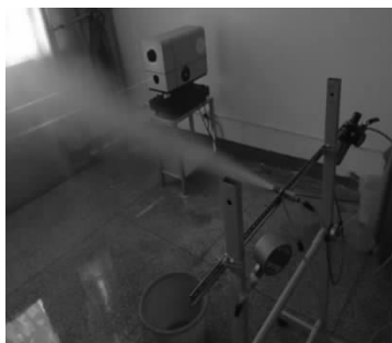
图3 两相流雾化喷头粒径谱测试装置图
