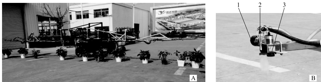
A:电磁阀控对靶喷雾机样机;B:喷雾机喷头集成。1:电磁阀;2:喷头;3:红外传感器。
