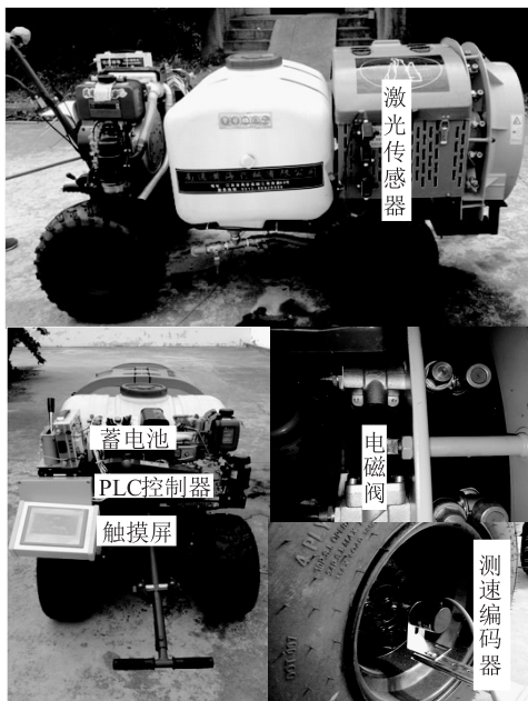
图5 移植对靶喷雾控制系统的喷雾机实物图
