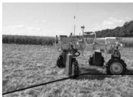
图 1 田间杂草检测农业机器人实物示例
