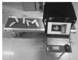
图 3 玉米种穗图像采集装置实物图
